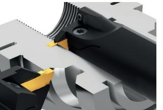
CNC profil tornalama. Hafif metallerin işlenmesi için özel geometriler ve full radius varyasyonu mevcuttur.
