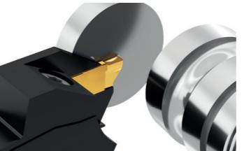
Farklı kesici genişlikleri ve köşe radiuslarına sahip takımlar CNC profil tornalama, özel talaş kırıcısı geometrisi ile hafif metallerin işlenmesi mümkündür. Ayrıca standart ürün yelpazemizde full radius takımlar mevcuttur.
