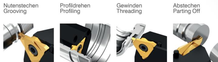
Wirtschaftlichkeit und Präzision sind kein Widerspruch. Dieses System ist ein ideales Beispiel dafür: Es bietet das bewährte Maß an Präzision und paart diese, durch die geschraubte Spannung der dreischneidigen Wendeschneidplatte, mit Leistungsfähigkeit und Stabilität.
