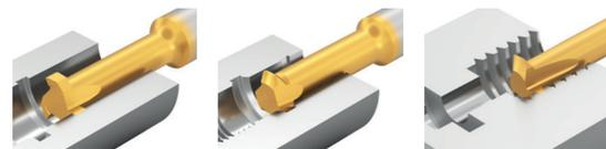
Schafffräser aus Feinstkornhartmetall für die Zirkularfräsbearbeitung von Bohrungen ab  $\varnothing$  1,4 mm. Verfügbar als drei- und z.T. vierschneidige Variante. Hohe Nutttiefen, sowie hohe Gewindetiefen bei reduziertem Schnittdruck, sind mit diesem Werkzeugsystem möglich.
