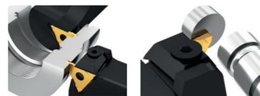
Werkzeugsystem bestehend aus dreischneidiger Hartmetall-Wendeschneidplatte und einer Auswahl an Stahl-Trägerwerkzeugen. Mögliche Stechtiefen bis 6,0 mm bzw. je nach Anwendung bis zu 8,0 mm bei der Außenbearbeitung. Verschiedene geschliffene Spanformgeometrien verfügbar.
